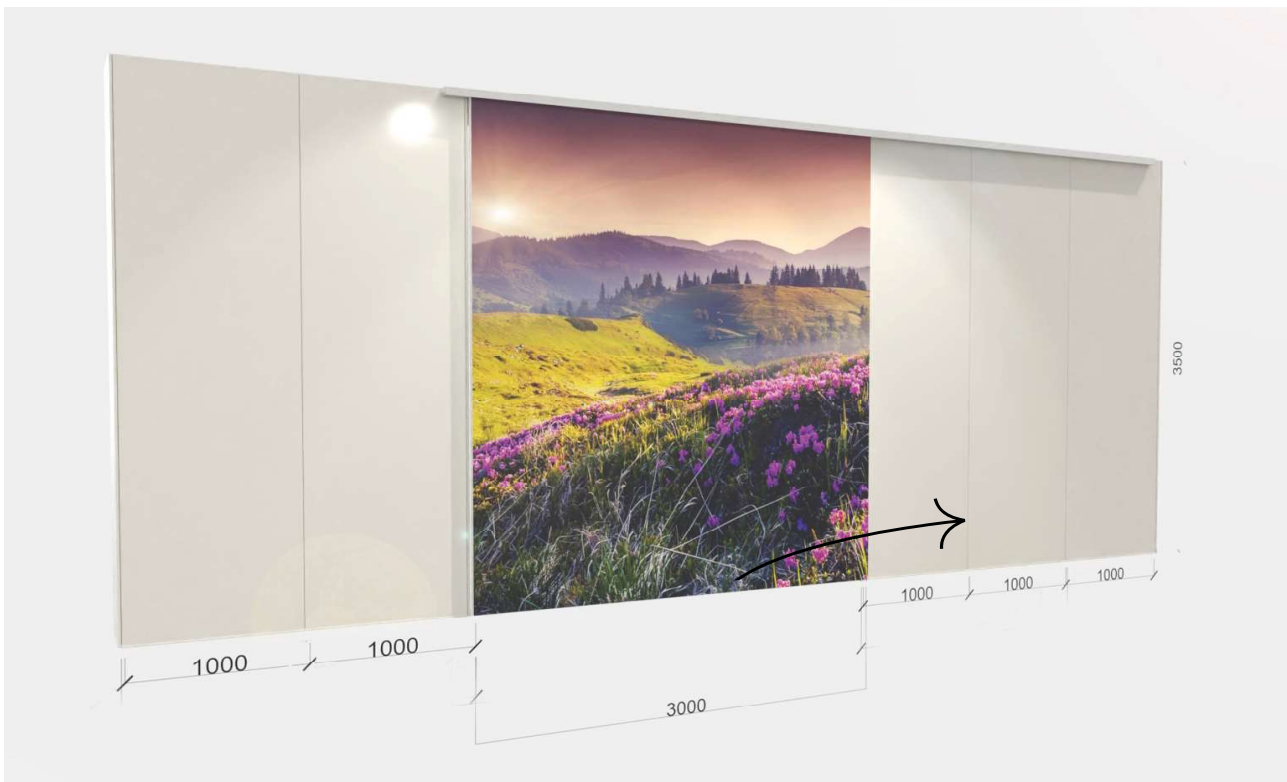
AUSFÜHRUNG der SCHIEBETÜR Breite 3000mm, Höhe 3500mm
