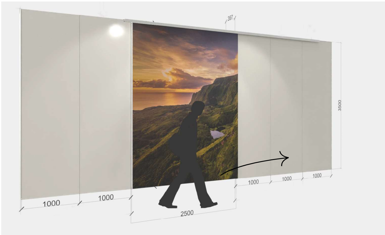
AUSFÜHRUNG der SCHIEBETÜR Breite 2500mm, Höhe 3500mm
