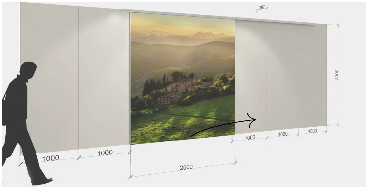
AUSFÜHRUNG der SCHIEBETÜR Breite 2500mm, Höhe 3000mm
